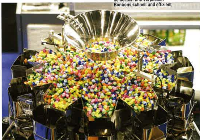
Tempomat: Die Industrie verlangt hohe Durchsätze. Moderne Süßwarenmaschinen bemessen und verpacken Bonbons schnell und effizient
