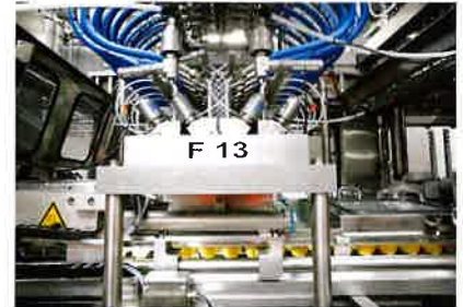
„Struldoseur für Aseptik Becher, FFS-Maschine“ der Hassia Verpackungsmaschinen GmbH
