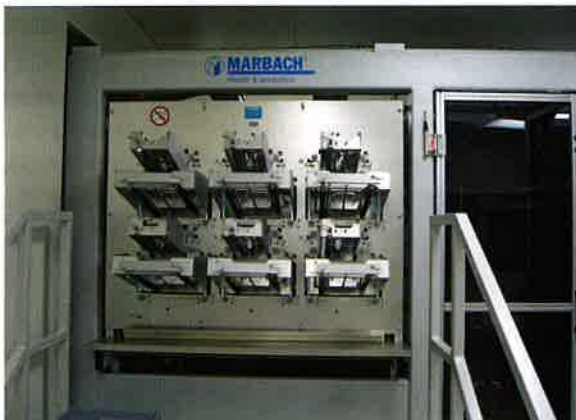
Die Magazine für Becher und Boden können während der Produktion nachgefüllt werden.
